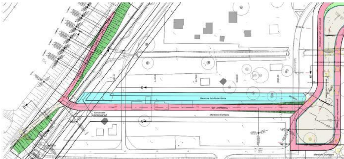
Abb.4: geplante Verkehrsanlage, Geh- und Radweg mit Rampen
